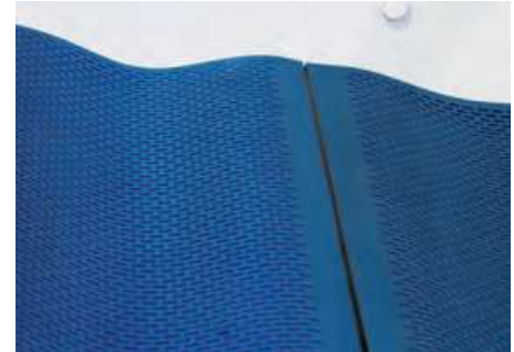
Esempio di vaglio vibrante "flip-flow" e dettaglio del tappeto vibrante
